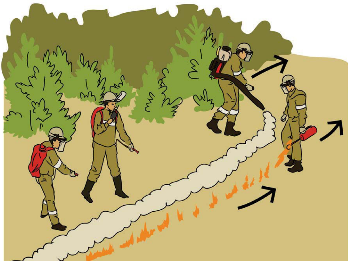
Рис. 6. Усиление опорной полосы валиком из пены, с помощью РЛО или воздуходувки.
